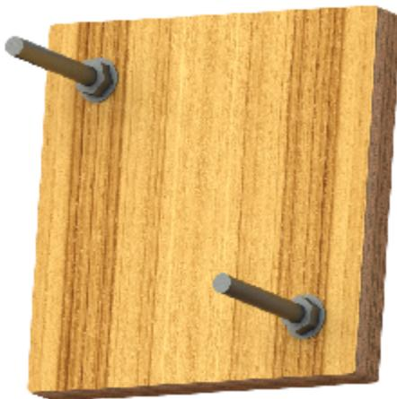
1- Percez la surface avec une mèche adaptée à 70 mm de profondeur, dépoussiez le trou.
